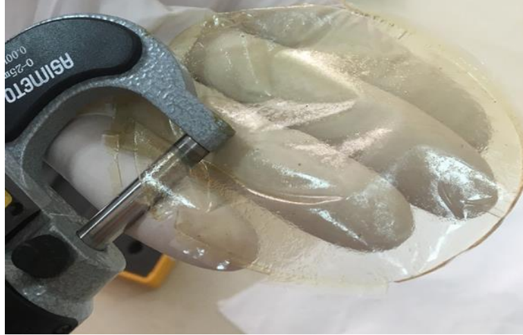
Şekil 2. Deneysel olarak üretilen filmlerin kalınlığının ölçülmesi (Orjinal)
