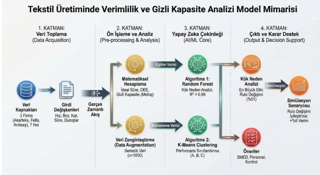
Şekil 1. Tekstil üretiminde verimlilik ve gizli kapasite analizi model mimarisi
