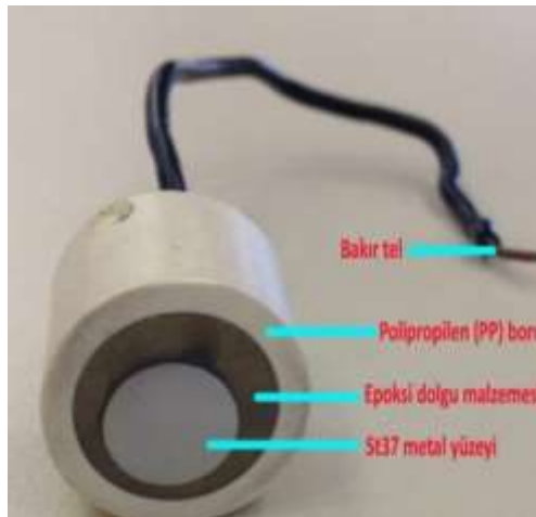
Şekil 3. Deneyde kullanılan elektrotların hazırlanış şekli (Figure 3. Preparation of the electrodes used in experiments)
