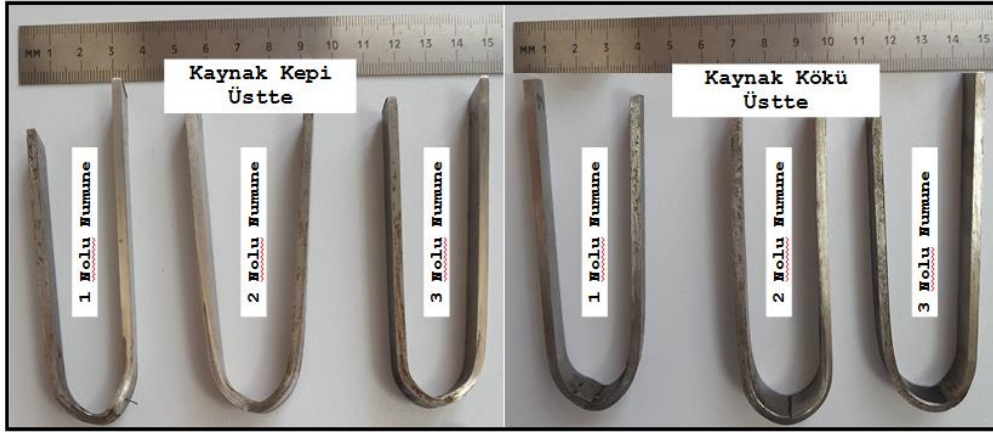
Şekil 4. Kaynaklı birleştirmelerin eğme testi sonucu görüntüleri (Figure 4. Bending test result images of welded joints)
