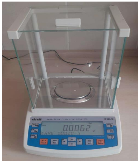
Şekil 2. Otolit ağırlıklarının tartılması (Radwag AS220/C/2 Terazi) (Figure 2. Weighing otoliths (using a Radwag AS220/C/2 Balance))
