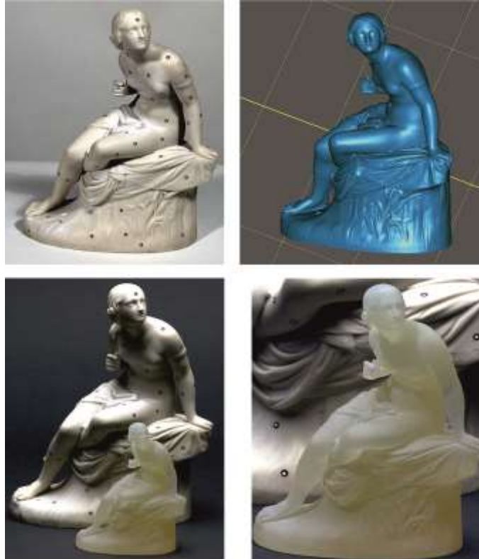
Görsel 1. Tarama yapılmış bir heykelin aslı ve modelin rp yöntemiyle photo polimerden üretilmiş kopyası (Maquette & Fine Art Scanning (Erişim: 04.04.2016, http://www.cyberfx.com/maquette_scan.htm )) (Image 1. A Sculpture screened of the original and model rp model photopolymer produced copy)
