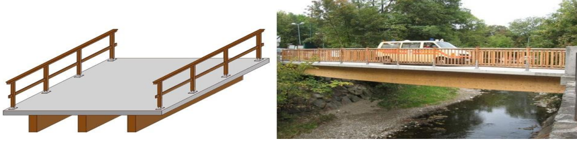
Şekil 6. Kirişli ahşap-beton kompozit döşemenin bir köprüde kullanımı (Figure 6. The use of timber-concrete composite beam floor in a bridge) [7]
