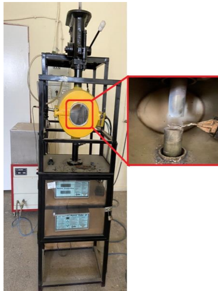
Şekil 1. Difüzyon kaynak makinası (Figure 1. Diffusion welding machine)
