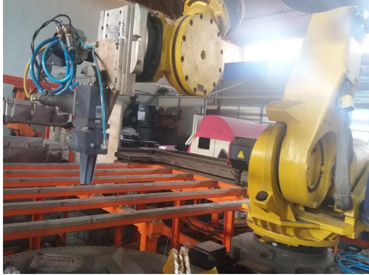
Şekil 1. Fiber lazer kaynak makinesi (Figure 1. The Fiber laser welding machine)
