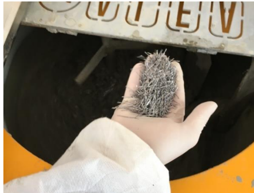
Şekil 2. Çelik lifin miksera eklenmesi (Figure 2. Adding of steel fibers in the pan mixer)
