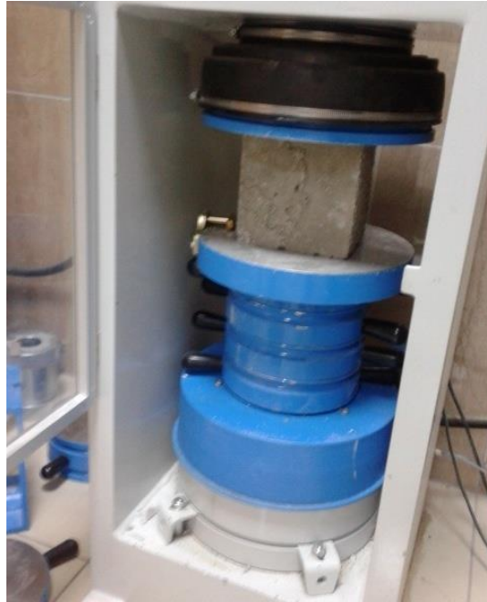
Şekil 4. Beton basınç dayanım deney düzeneği (Figure 4. The test setup of compressive strength of concretes)
