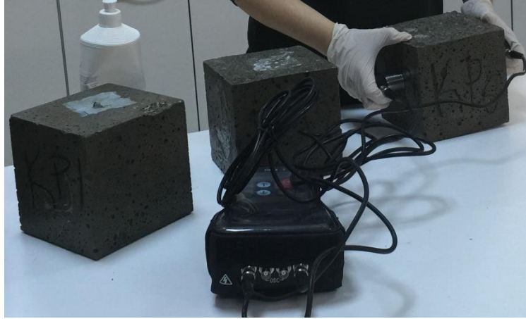
Şekil 3. Ultrases geçiş hızı deneyi (Figure 3. The test of ultrasonic pulse velocity)
