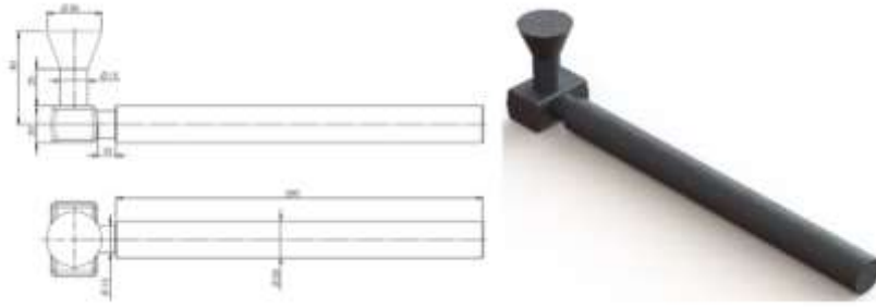
Şekil 1. Döküm deneylerinin yapıldığı model ölçüleri ve katı model görüntüsü (Figure 1. Model measurements of casting tests and solid model figure)
