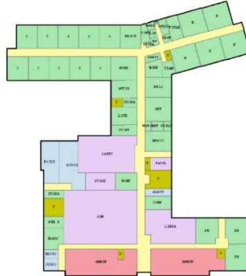
Resim 9. Genetik algoritma tarafından, mekânlar arası ilişkileri en kısa dolaşım alanları ile sağlanacak şekilde optimize edilmesi beklenen asıl plan [29]
