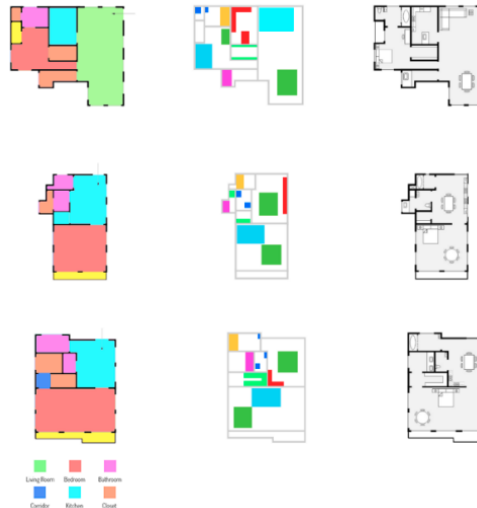
Resim 4. Sistem tarafından mekânsal ve işlevsel olarak tanımlanarak bölümlenmiş yerleşimlerin, tefriş yerleşiminin gerçekleştirilmesi [28] (Picture 4. The spatial and functional identification of the settlements and the furnishing settlement by the system)
