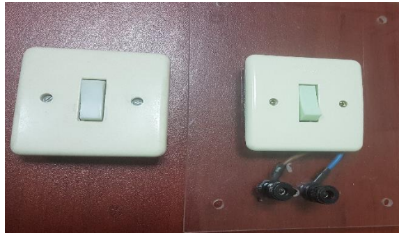
Şekil 3. Tek kutuplu anahtarın önden görünüşü (Figure 3. Front view of unipolar switch)
