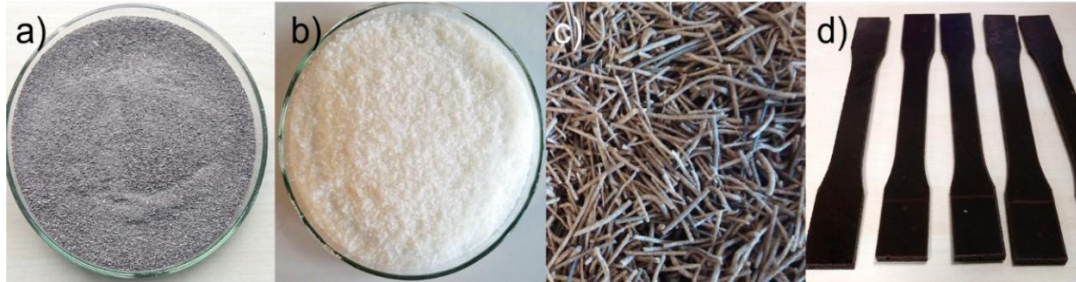
Şekil 2. a) Öğütülmüş manda boynuzu b) Öğütülmüş PLA c) Ekstrüderlenmiş manda boynuzu takviyeli PLA biyokompozit d) Standart çekme örnekleri (Figure 2. a) Ground buffalo horn b) Ground PLA c) Extruded buffalo horn reinforced PLA biocomposite d) Standart tensile samples)
