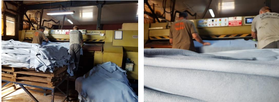
Fotoğraf 8. Tıraş makinası ve tıraşlama işlemi (Image 8. Shaving machine and shaving operation)
