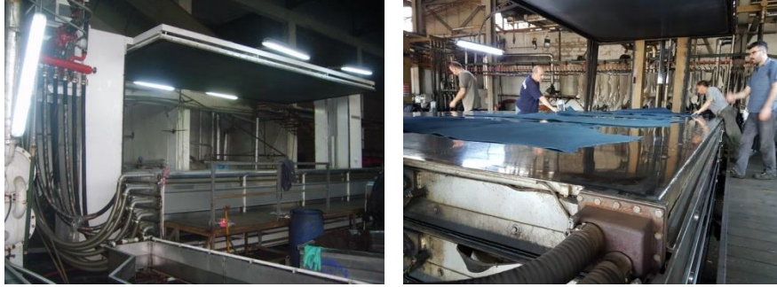
Fotoğraf 10. Vakum kurutma makinası ve vakum kurutma işlemi (Image 10. Vacuum drying machine and vacuum drying operation)
