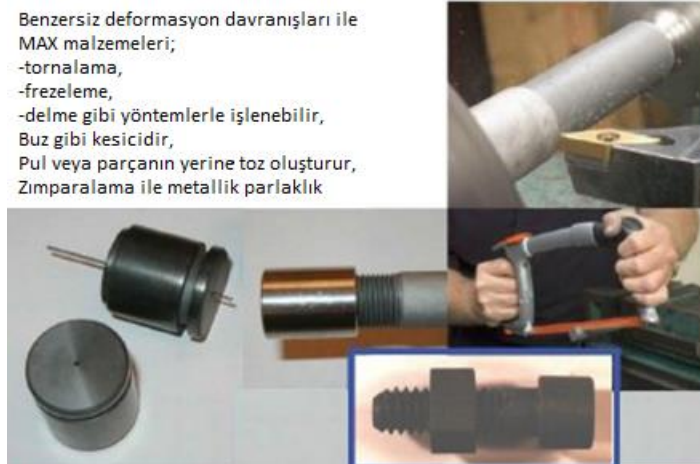
Şekil 1. MAX Malzemeleri, Metaller Gibi İşlenebilir ve Ti Yoğunlu ile Aynı Olmasına Rağmen Dayanımı Ti'dan Üç Kat Daha Fazladır. Resimler, Drexel Üniversitesi'nden Lisansını Alan Kanthal Şirketi'ne Aittir [5] (Figure 1. MAX Materials are machinable as Metals and are three times more resistant than Ti to the same degree as the Ti Concentrate)
