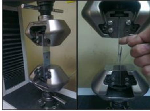
Şekil 2. Çekme testinin uygulanışı (Figure 2. Application of the tensile test)
