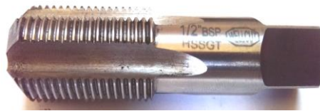
Şekil 2. Welcut 1/2" BSP kılavuz resmi (Figure 2. Welcut 1/2" BSP tap tool)
