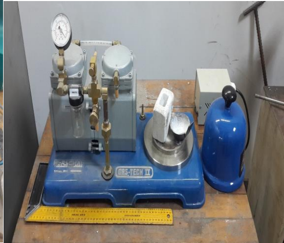
Şekil 2. (a) Ultrasonik gaz giderme cihazı ve (b) VAK (Vakum Altında Katılaştırma=RPT) cihazı (Figure 2. (a) Ultrasonic degassing equipment, (b) Reduced Pressure Test Equipment)
