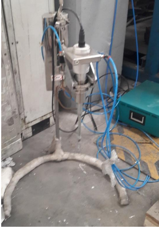
Şekil 2. (a) Ultrasonik gaz giderme cihazı ve (b) VAK (Vakum Altında Katılaştırma=RPT) cihazı (Figure 2. (a) Ultrasonic degassing equipment, (b) Reduced Pressure Test Equipment)
