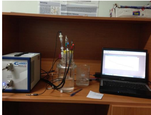
Şekil 3. Korozyon deney düzeneği (Figure 3. Corrosion tester)
