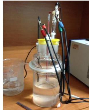
Şekil 3. Korozyon deney düzeneği (Figure 3. Corrosion tester)
