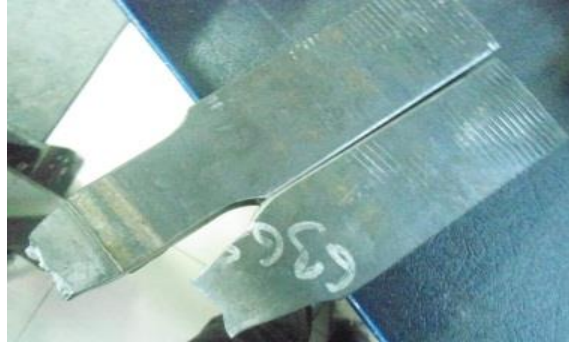
Şekil 3. Kaynatılmış çekme numunesi (Figure 3. Welded tensile Sample)
