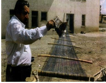
Fotoğraf 7. Ste'den geçirilen tiftik ipinin inceltilmesi, temizlenmesi için "ska"ya aktarılarak bitki köklerinden yapılmış fırça ile çirişlenmesi (haşılanması) (Photo 7. The thinning of the mohair passed from Ste is transferred to the "Ska" for cleaning and is made with a brush made of plant roots (stinging))
