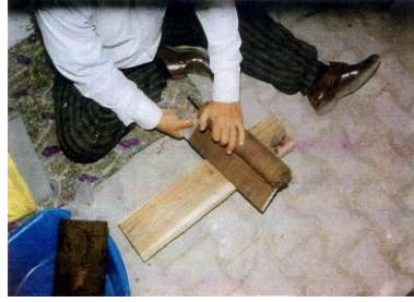
Fotoğraf 14. Bir adet çelik levhaya sarılan tüm kumaşın iki eşit şekilde sarılması ve çözülmemesi için yarım kumaşın ikinci çelik levhaya sarılması (Photo 14. Two equally wrapped entire fabrics in one steel plate and wrapping the half-fabric to the second steel plate to prevent it from dissolving)
