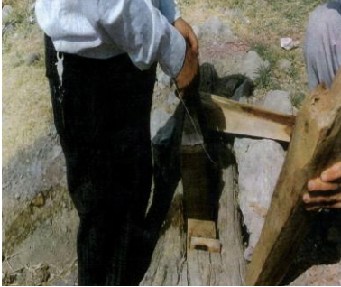
Fotoğraf 19. 12 saat boyunca "kuç"da kalıba konulan kumaşın çıkarılması
