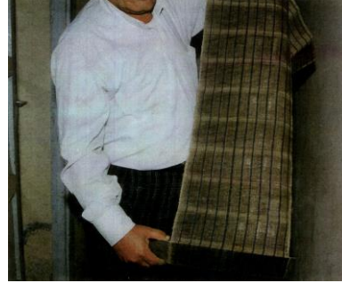
Fotoğraf 20. Kalıptan çıkarılan kumaşın sarılı olduğu çelik levhadan çözündürülmesi (Photo 20. The fabric removed from the mold dissolving wrapped steel plate)
