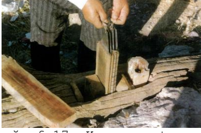
Fotoğraf 17. Kumaşın oturması, ebruleşmesi için "kuç" denilen kalıba yerleştirilmesi ve "kuç" haznesine yerleştirilen kumaşın kalaslarla (4 adet spine) dengelenmesi
