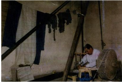
Fotoğraf 9. Ska'da işlenen tiftik ipinin tezgaha geçirilerek dokuma işlemi için hazır vaziyete getirilmesi (Photo 9. Ska'dan processed lint yarn is put on the bench and ready for weaving process is brought)
