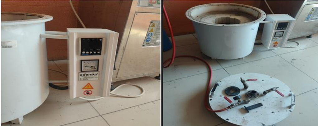
Şekil 2. Sinterleme fırınının iki ayrı görüntüsü (Figure 2. Two separate views of the sintering furnace)
