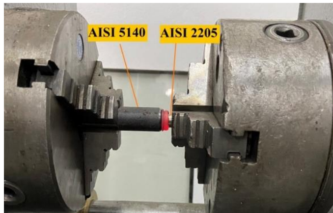
Şekil 1. Numunelerin sürtünme kaynağındaki konumları (Figure 1. Positions of samples in friction welding)
