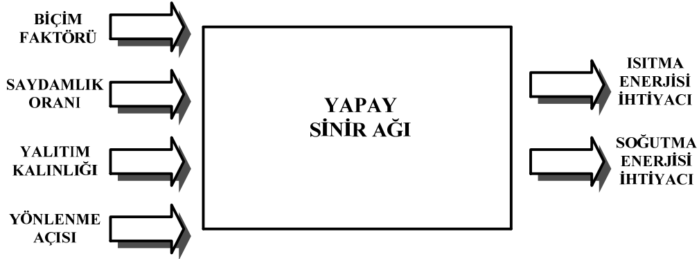
Şekil 4. Enerji ihtiyacı tahmini için oluşturulan ağ yapısı Figure 4. The network structure formed for energy prediction
