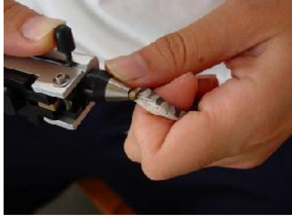
Şekil 19. El ile kullanılan çoklu CWT markalama tabancası [27] Figure 19. Hand-operated multi-CWT marking gun
