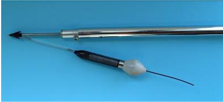
Şekil 23. Uydu iletimli marka ve sabitleme dartı [30] Figure 23. Satellite transmission brand and fixing dart
