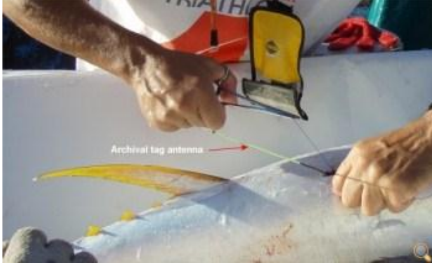
Şekil 22. Veri depolu markanın balığa yerleştirilmesi [32] Figure 22. Placement of archival brand to fish
