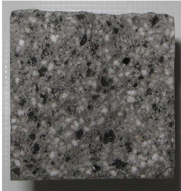
Şekil 4. Kendiliğinden yerleşen hafif harç kesiti (Figure 4. Section of self compacting lightweight mortar)
