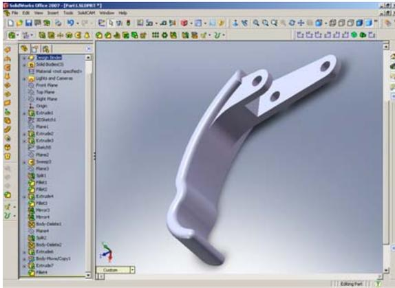
Figure 5. The Door Handle Model Has Been Prepared in Solidworks (Şekil 5. Kapı Kolu Modelinin Solidworks'de Hazırlanması)
