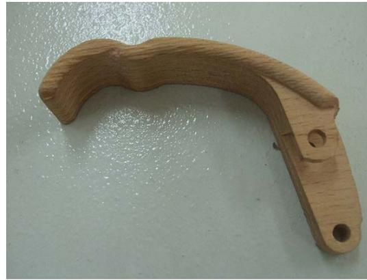
Figure 6. Manufactured from Wood Ergonomic Interior Doors Handle (Şekil 6. Ergonomik Kapı Kolunun Ahşaptan Üretilmiş Şekli)
