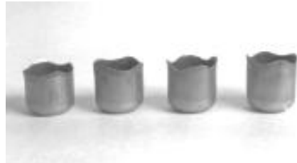
Şekil 1. Kulaklaşmış kap örnekleri (Al 5082 malzemesine ait)[3] (Figure 1. Samples of vessel earing (for Al 5082))
