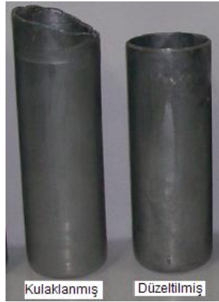
Şekil 3. Son kademe elde edilmiş kulaklanmış ve düzeltilmiş numuneler (Figure 3. Uncorrected and corrected vessels obtained at last stage)
