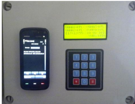
Şekil 5. Sulama otomasyonu kontrol birimi genel görüntüsü (Figure 5. General display of irrigation automation control unit)
