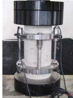
Şekil 2. Elastisite modülü deneyi (Figure 2. E-Modulus test)
