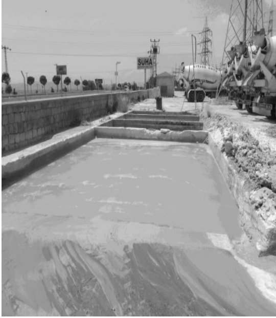
Şekil 3 ve Şekil 4. Süha hazır beton tesisinde yer alan geri dönüşüm havuzu (Figure 3 and Figure 4. Recycle pool in Suha ready-mixed concrete plant)
