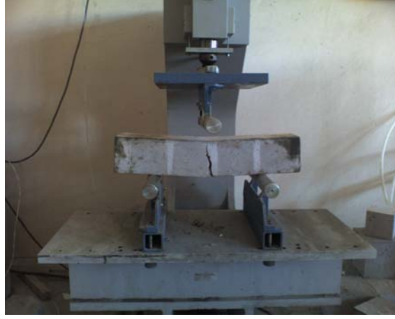
Şekil 1. Eğilme dayanımı deney düzeneği (Figure 1. Experimental mechanism of the bending strength)
