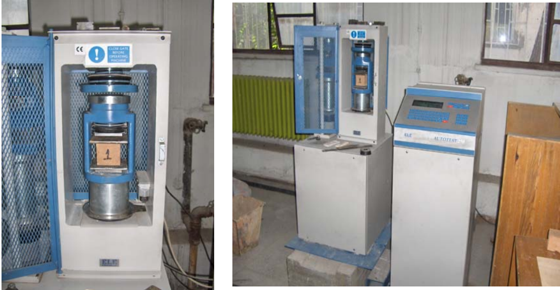
Şekil 2. Basınç dayanımı deneyi (Figure 2. Compression stress test)
