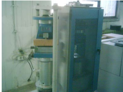
Şekil 3. Eğilmede çekme deneyi (Figure 3. The tensile strength of bending test)
