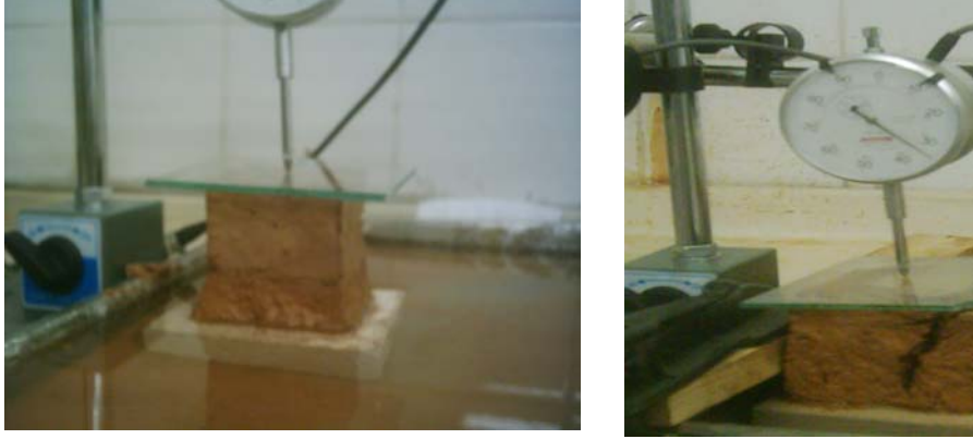
Şekil 1. Kerpic şişme deneyi (Figure 1. Adobe swelling test)
