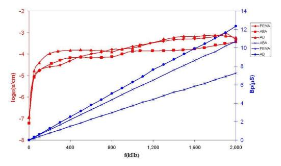
Figure 4. The susceptance and AC conductivity as a function of frequency (Şekil 4. Frekansın bir fonksiyonu olarak susseptans ve AC iletkenliğinin Değişimi)
