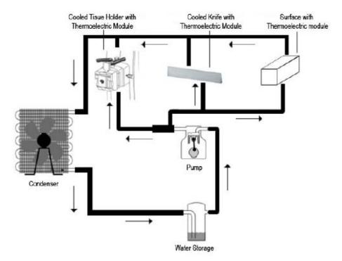
Figure 5. Diagram of water circulation system (Şekil 5. Su dolaşım sisteminin diyagramı)
