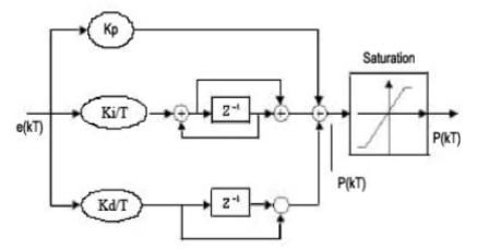
Figure 3. Structure of the realized PID controller (Şekil 3. Farklı PID denetleyicisinin yapısı)
