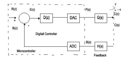
Figure 2. Block diagram of a closed loop digital controller (Şekil 2. Bir kapalı devre dijital denetleyicinin control şeması)
