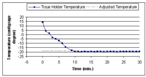
Figure 9. Tissue holder temperature variation graph (Şekil 9. Doku tutucu sıcaklık değişim grafiği)
