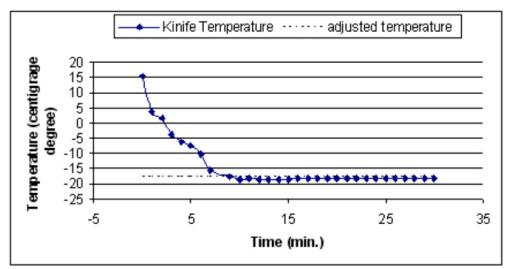
Figure 10. Microtome knife temperature variation graph (Şekil 10. Mikroatom bıçak sıcaklık değişim grafiği)
