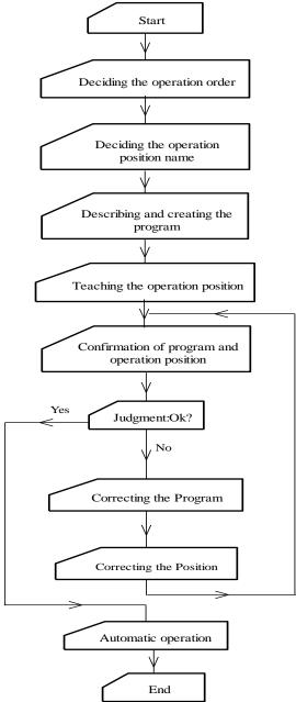
Figure 4. Flow chart of robot application process (Şekil 4. Robot uygulama işleminin akış şeması)
