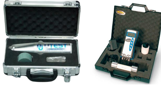
Resim 13. Beton Test Çekici (Schmidt Çekici) ve Ultrasonik Sinyal Hızı Test Cihazı [URL-1] (Photo 13. Concrete test hammer (Schmidt Hammer) and ultrasonic signal velocity tester) [URL-7]
