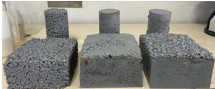
Resim 3. Kalıptan çıkarılan numuneler (Picture 3. Samples removed from the mold)
