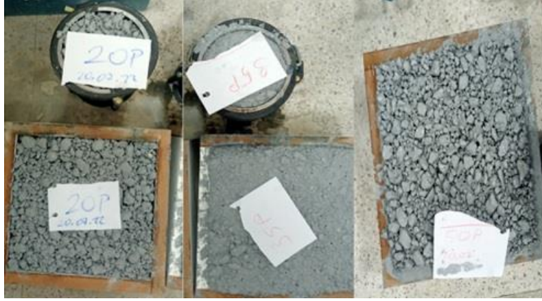
Resim 1. Hafif agregalı polimer malzemelerin üretilmesi (Figure 1. Production of lightweight aggregate polymer materials)
