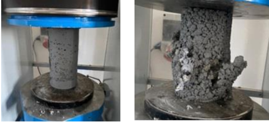
Resim 4. Numunelerin basınç dayanımı deneyi (Picture 4. Compressive strength test of samples)
