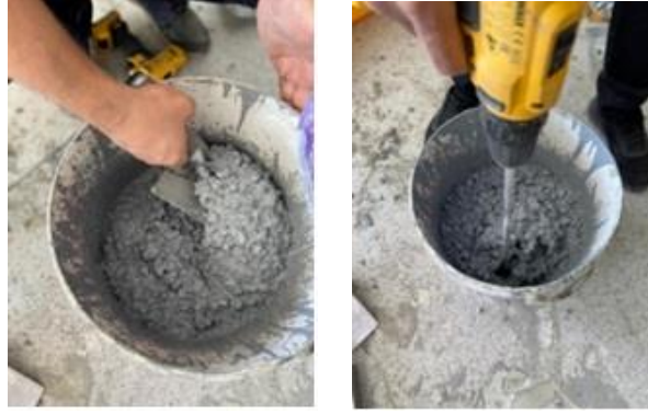
Resim 1. Agregata ve polimerlerin karıştırılması (Picture 1. Mixing of aggregates and polymers)
